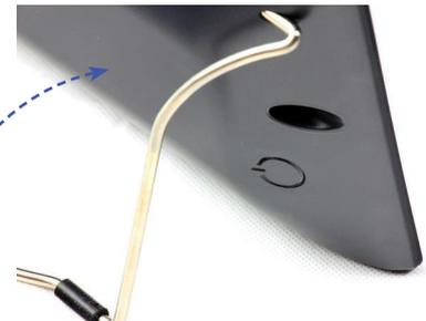
Les rails métalliques derrière la trappe amovible permettent de placer d'autres modules, mais surtout le Raspberry Pi. Les aimants sont très puissants et l'ouverture sur le côté permet d'avoir accès aux ports USB et RJ45. L'unique alimentation (pour l'écran et le Raspberry) n'est pas micro-USB, mais au format jack 5 mm. Le bouton de mise en marche est un peu raide par contre la tige en métal au dos permet d'incliner le Pi-top CEED sur 65°.
