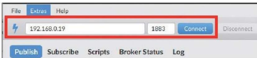
Le message doit être visible dans MQTT.fx, sinon il y a un problème de communication. On retrouve le même principe qu'avec les messages avec les subscribers et les publishers (voir plus haut). Si la commande n'est pas exécutée sur le serveur Mosquitto, il vous faut ajouter le paramètre de l'hôte `-h 192.168.0.19`.
