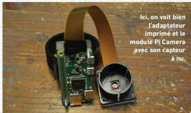
Ici, on voit bien l'adaptateur imprimé et le module Pi Camera avec son capteur à nu.
