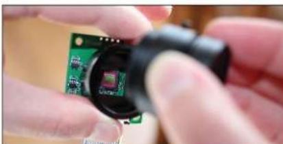
En effet, la différence entre une monture C et une monture CS se situe au niveau du «tirage». Le tirage est la distance entre le capteur et le «cul» de l'objectif. Avec une monture CS, il faudra une bague supplémentaire permettant d'ajouter ces 5mm qui sont bien sûr indispensables à la capture d'une image nette. Mais comment faire le lien entre le couple objectif/ adaptateur et le Raspberry Pi ? Il
